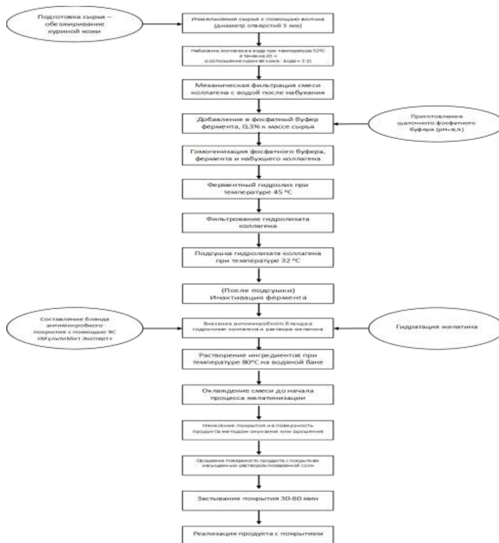
Рисунок 1 – Схема получения съедобного пищевого покрытия
