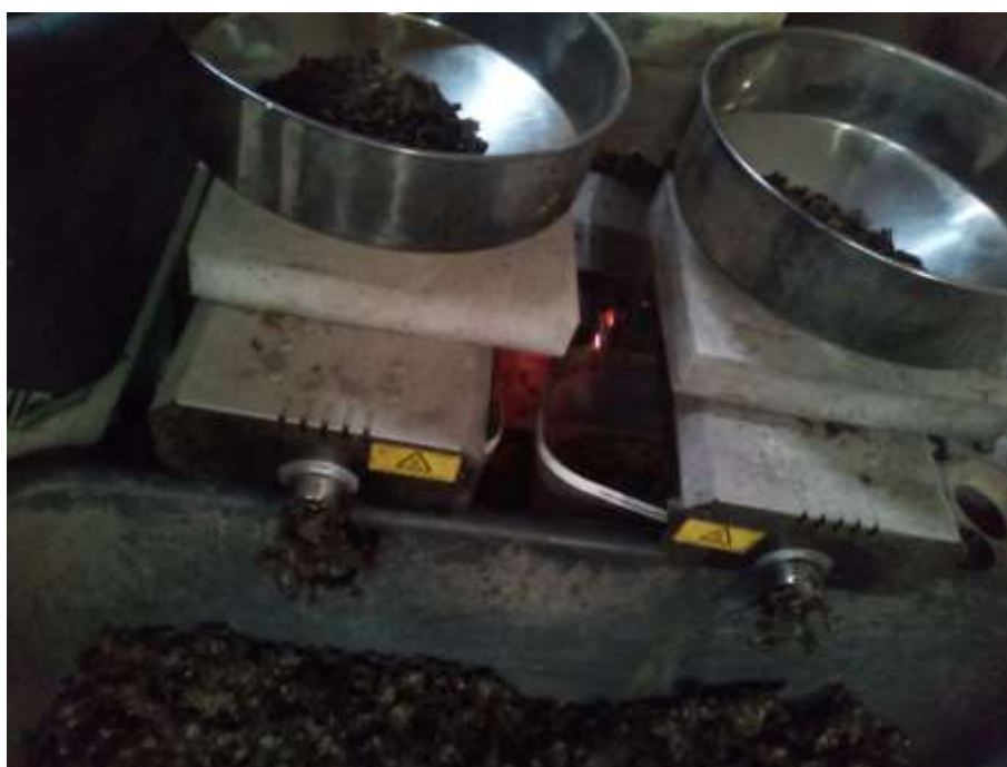
Рисунок 3 – Получение жмыха из личинок чёрной львинки
