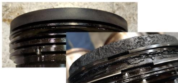
а) Повышенное нагарообразование на деталях цилиндропоршневой группы
