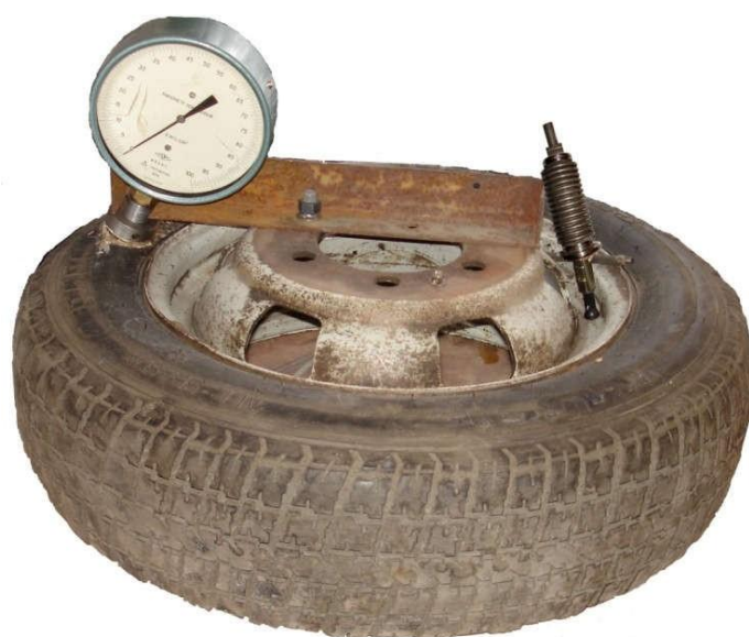
Рисунок 2. - Установка для определения интенсивности диффузии при постоянном давлении за счет компенсации объема диффундирующего газа металлическим сиффоном
