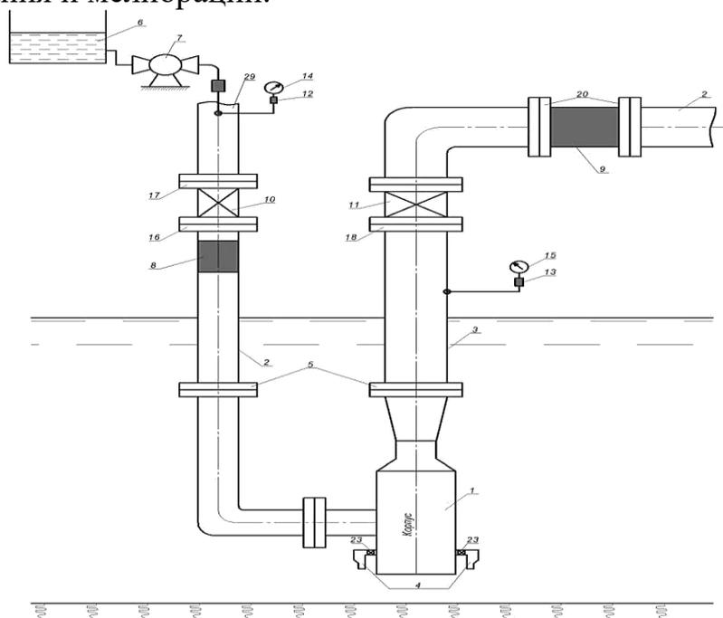
**Схема установки струйного насоса на канализационных очистных сооружениях**
