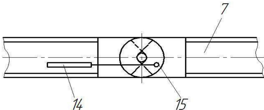
**Фиг. 6** Механизм поворота боковой секции поперечной балки
