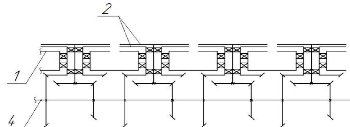
Рис. 1. Схема режущего аппарата косилки.
