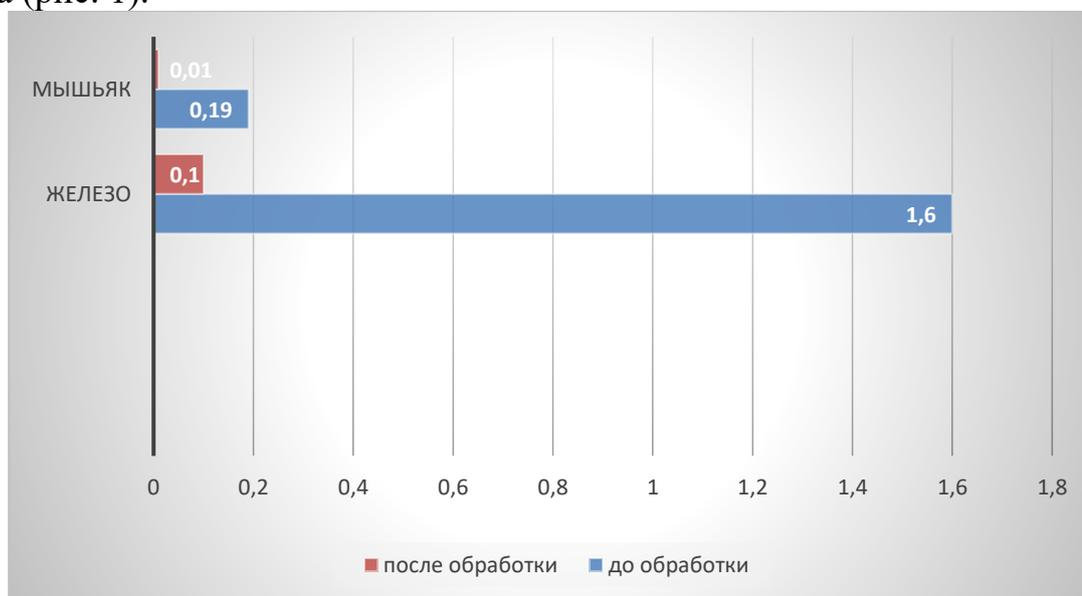
Рисунок 1- Результаты использования сорбента для очистки воды от мышьяка на примере п. Богатыревка
