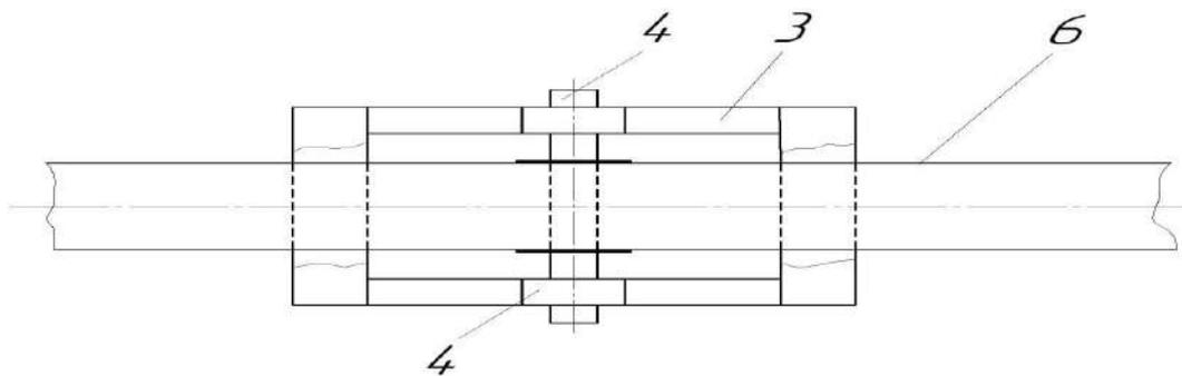
**Фиг. 4** Рама с центральной секцией поперечной балки
