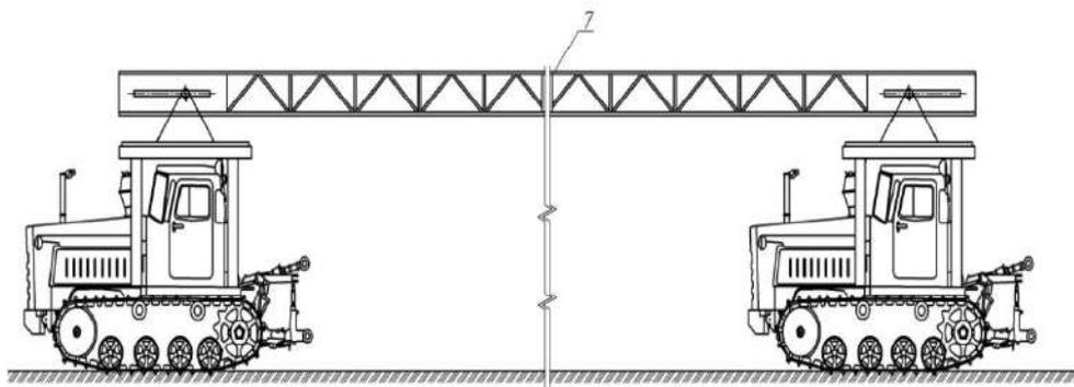
**Фиг 4 Мостовой агрегат (вид сбоку при смене позиций)**
