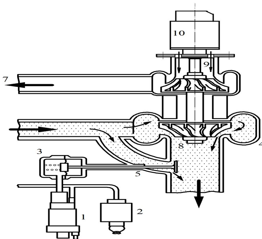
**Рис.2. Схема турбокомпрессора после усовершенствования**
