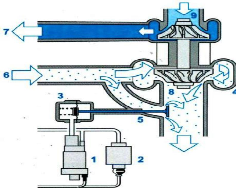
**Рис. 1. Схема турбокомпрессора до усовершенствования**
