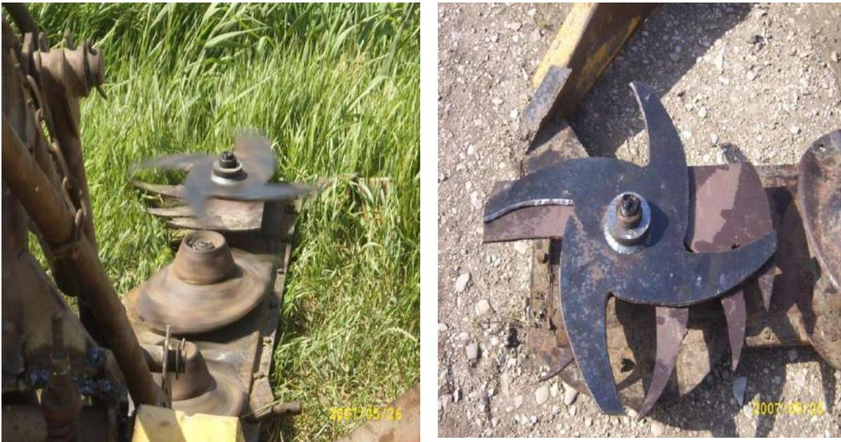
Рис. 4. Общий вид режущего аппарата косилки.
