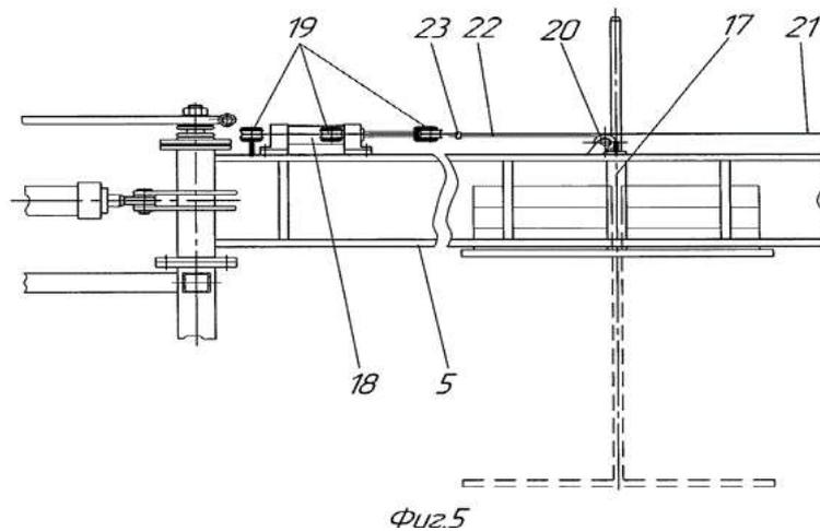
Фиг.5 - Механизм подъема и опускания поддонов, место Б (фиг.2).
