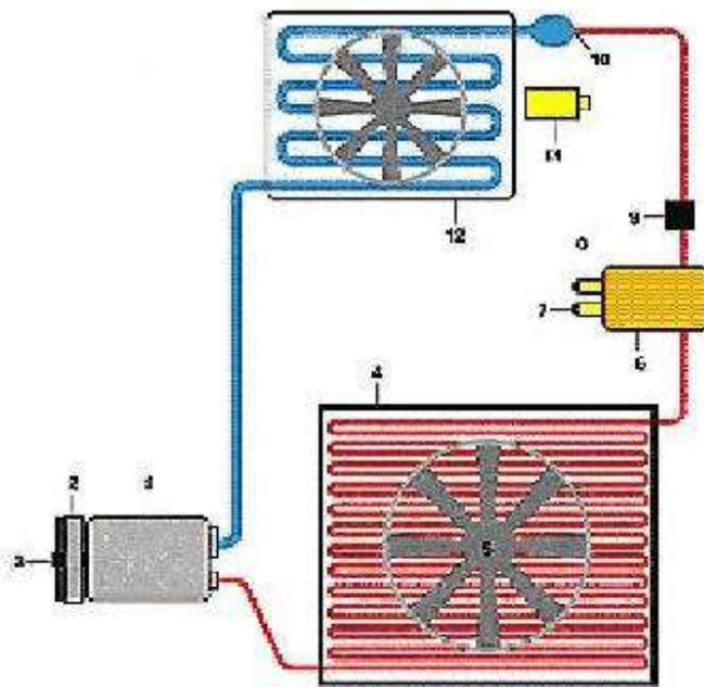
Рис. 1. Схема установленного на автомобиле кондиционера (основные узлы): компрессор; 2 – шкив; 3 – диск прижимной; 4 – радиатор; 5 – вентилятор.
