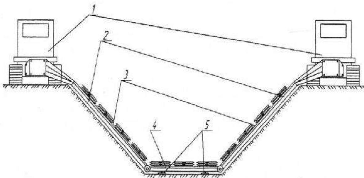
**Рис. 2. Косилка роторная полнопрофильная КРПФ-2,5А. Патент РФ № 86387:** 1 - трактор типа ДТ-75МБ; 2 - косилка роторная для скашивания растительности на откосах канала; 3 - привод косилки; 4 - косилка роторная для скашивания растительности на дне канала; 5 - ложка опорная.
