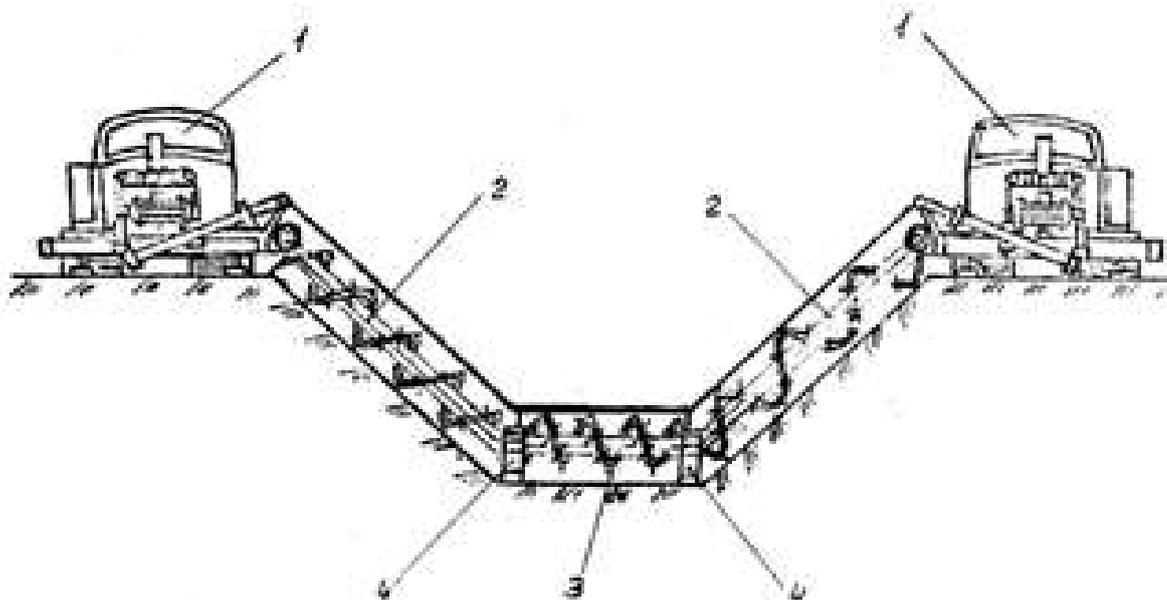
**Рис. 1. Косилка шнековая полнопрофильная КШПФ-2,5А:** 1 - трактор типа ДТ-75МБ; 2 - косилка шнековая для скашивания растительности на откосах канала; 3 - косилка шнековая для скашивания растительности на дне канала; 4 - ложка опорная.
