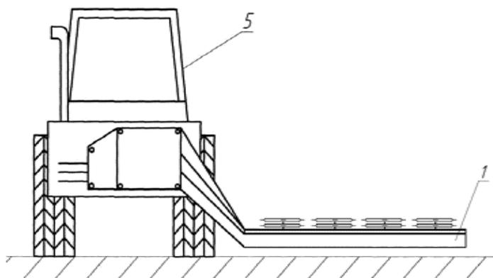
Рис. 3. Схема установки косилки на транспортное средство.
