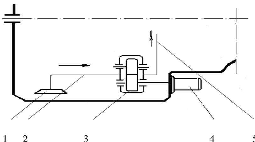
**Рис. 2. Схема системы смазки ДВС с электроприводным насосом:**
