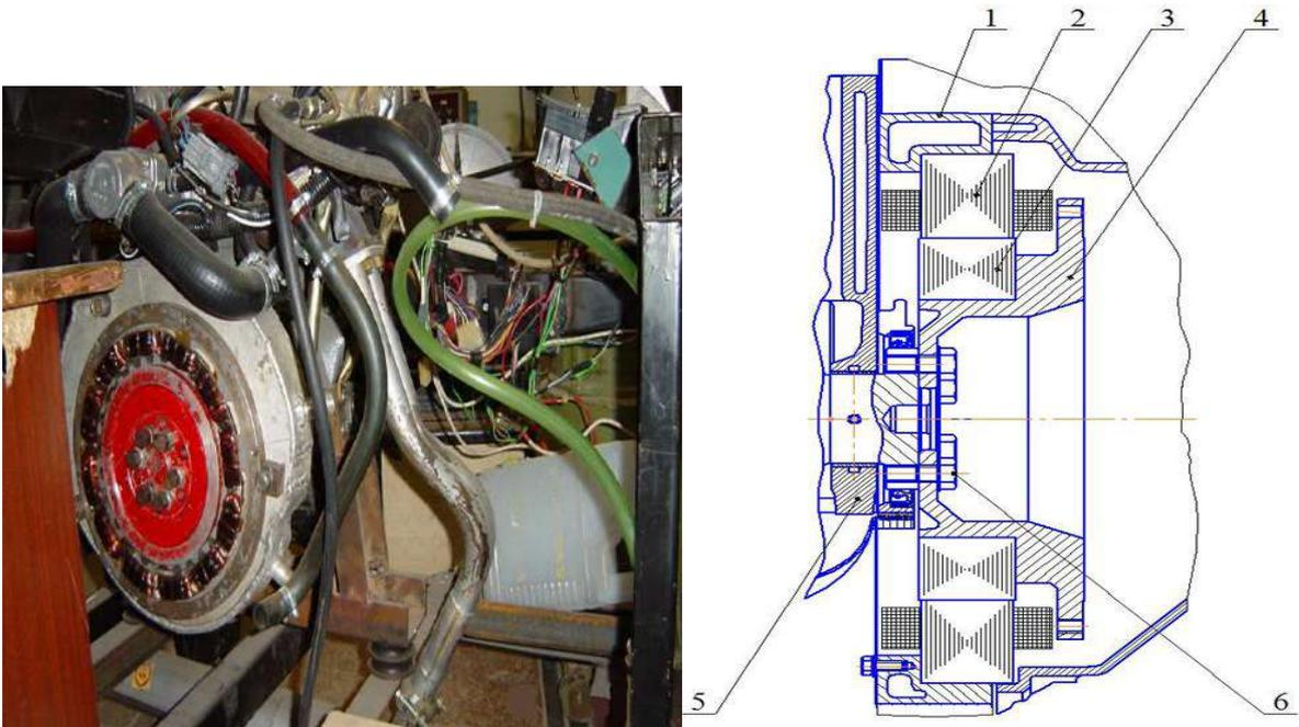
Конструктивное решение размещения электрической машины starter-генераторного устройства.
