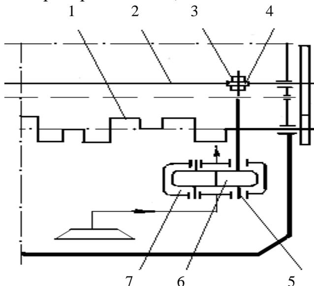
**Рис. 1. Схема системы смазки ДВС с приводом от коленчатого вала:**
