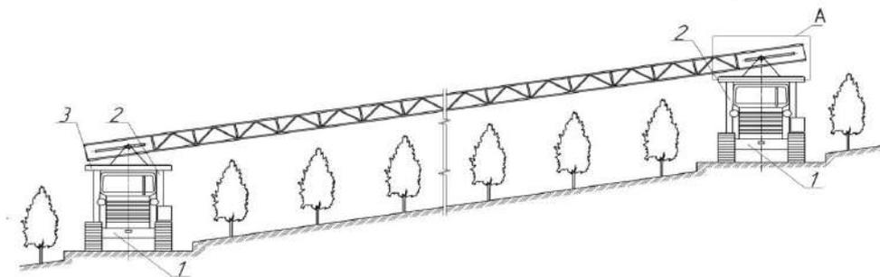
**Фиг. 1** Мостовой агрегат
