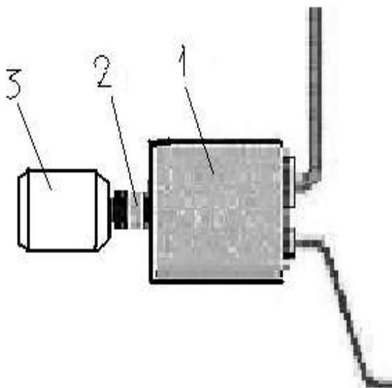
Рис. 2. Схема заменяемого узла предлагаемого автомобильного кондиционера с электрическим приводом: 1 – компрессор; 2 – муфта; 3 – электромотор.
